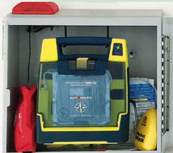
En effet, l'autotest est alimenté par la source principale de l'appareil (batterie ou piles). En cas de déchargement de ces piles ou batterie, l'autotest n'est plus en état de fonctionner et de diagnostiquer/signaler une déféctuosité de l'appareil. Par exemple, un DAE qui va « bipper » pour un défaut d'électrodes va obligatoirement décharger la batterie dans un délai plus ou moins long selon le taux de charge... Et après la fin du bip ?
